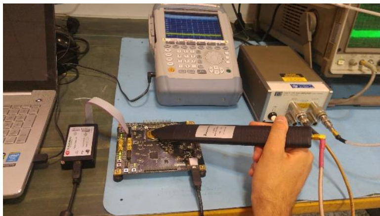
شکل ۷- بستر آزمایش با استفاده از اسیلوسکوپ دستی Rohde & Schwarz
